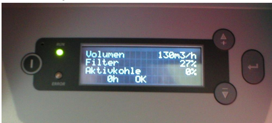
Bild 7: Folienbedienfeld mit Klartextanzeige (Standardeinstellung)
