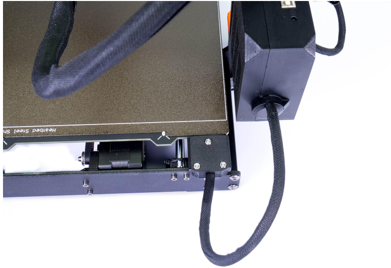
Bild 49 - Die Kabel sollten in einen Textilschlauch eingewickelt werden
