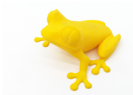
Bild 25 - der 50-Mikrometer-Baumfrosch wird häufig als 3D-Druck-Benchmark verwendet.
