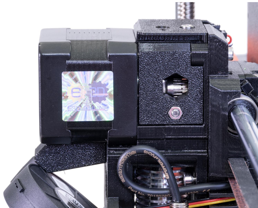
Bild 40 - Reinigen des Extruders - hier sehen Sie die Antriebsritzel durch das Wartungsloch
