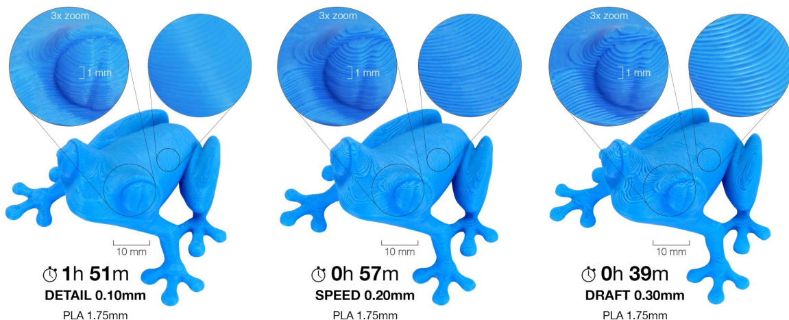
Bild 19 - Druckqualität vs. Druckzeit
