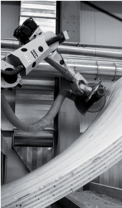
Robotische Holzbearbeitung Finnforest-Merk
